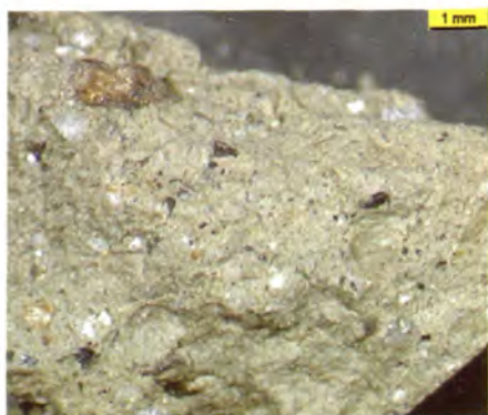
Probe: LGR 5/5, (AL) Bruchfläche einer ungebrannten Graphittonkeramikscherbe: feine Einschlüsse von Graphit, groben, bräunlich verwitterten Gesteinsbruchstücken sowie Quarzen und Feldspäten.
