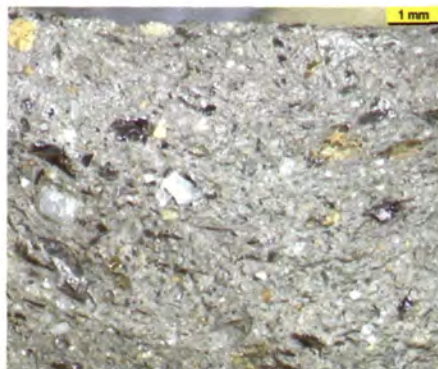
Probe: LGR 5/3, (AL) Bruchfläche einer ungebrannten Graphittonkeramikscherbe: Einschlüsse von Grafit, bräunlich verwitterten Gesteinsbruchstücken sowie Quarzen und Feldspäten.
