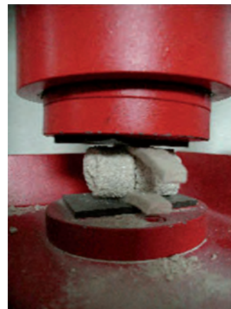
Abb. 34. Versuchsanordnungen zur Messung von Spaltzugfestigkeit: quer (a, b) und längs (c) zur Achse des Prüfkörpers.
