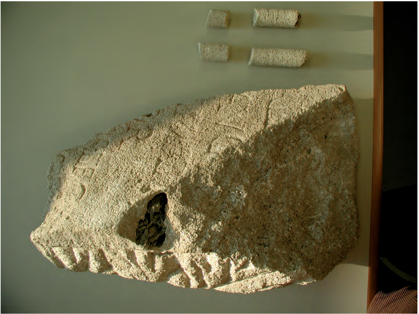
Abb. 22. Inschriftenfragment 3/28 – Kalkbrezie mit entnommenen Bohrproben.
