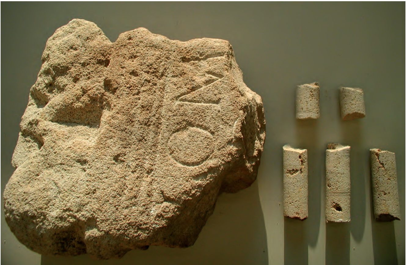
Abb. 26. Inschriftenfragment 6/50 – Kalkoolith mit entnommenen Bohrproben.
