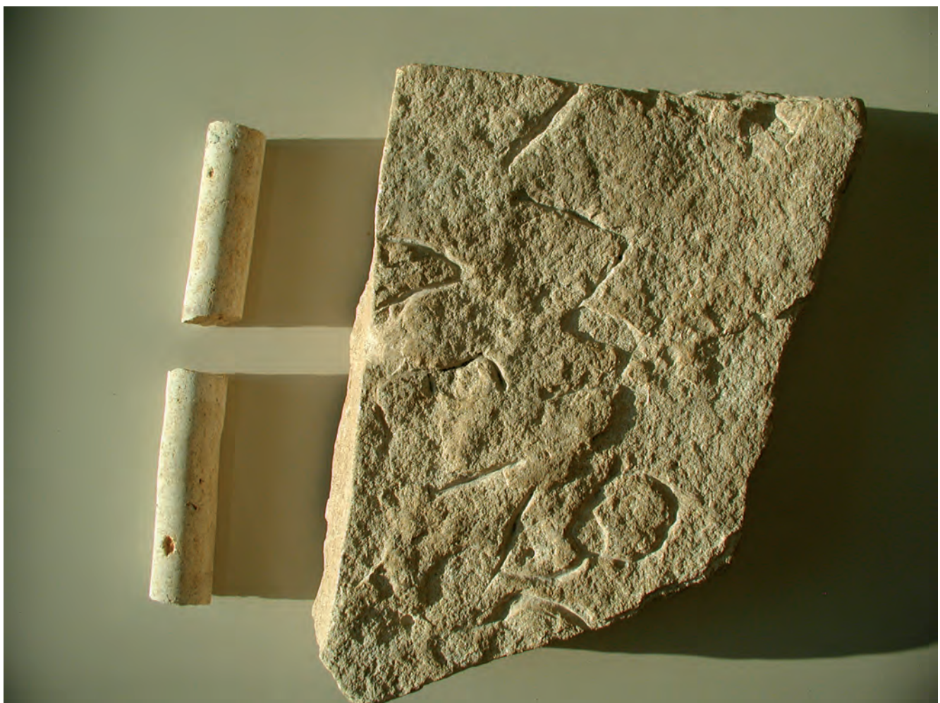
Abb. 17. Inschriftenfragment 2/126 – dichter Fossilkalk mit entnommenen Bohrproben.
