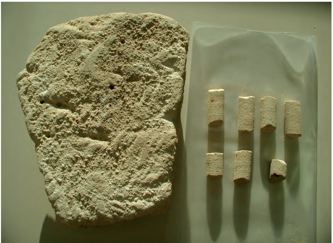
Abb. 15. Inschriftenfragment 1a/313 – Kalksandstein mit entnommenen Bohrproben.
