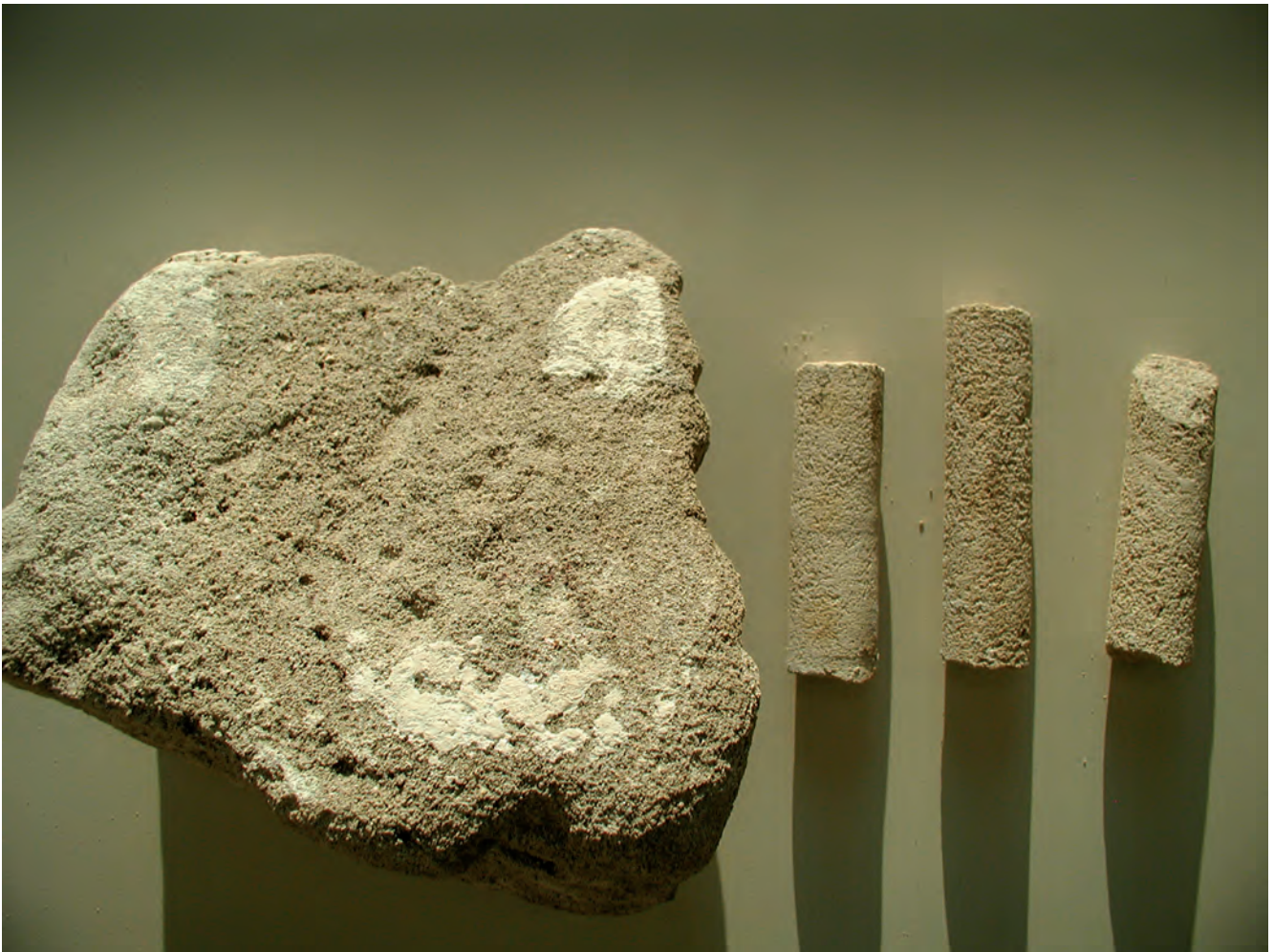
Abb. 25. Inschriftenfragment 4/40 – Lithothamnienkalk mit entnommenen Bohrproben.
