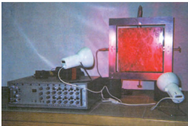
Abb. 38. Gerät zur Messung des thermischen Ausdehnungskoeffizienten.
