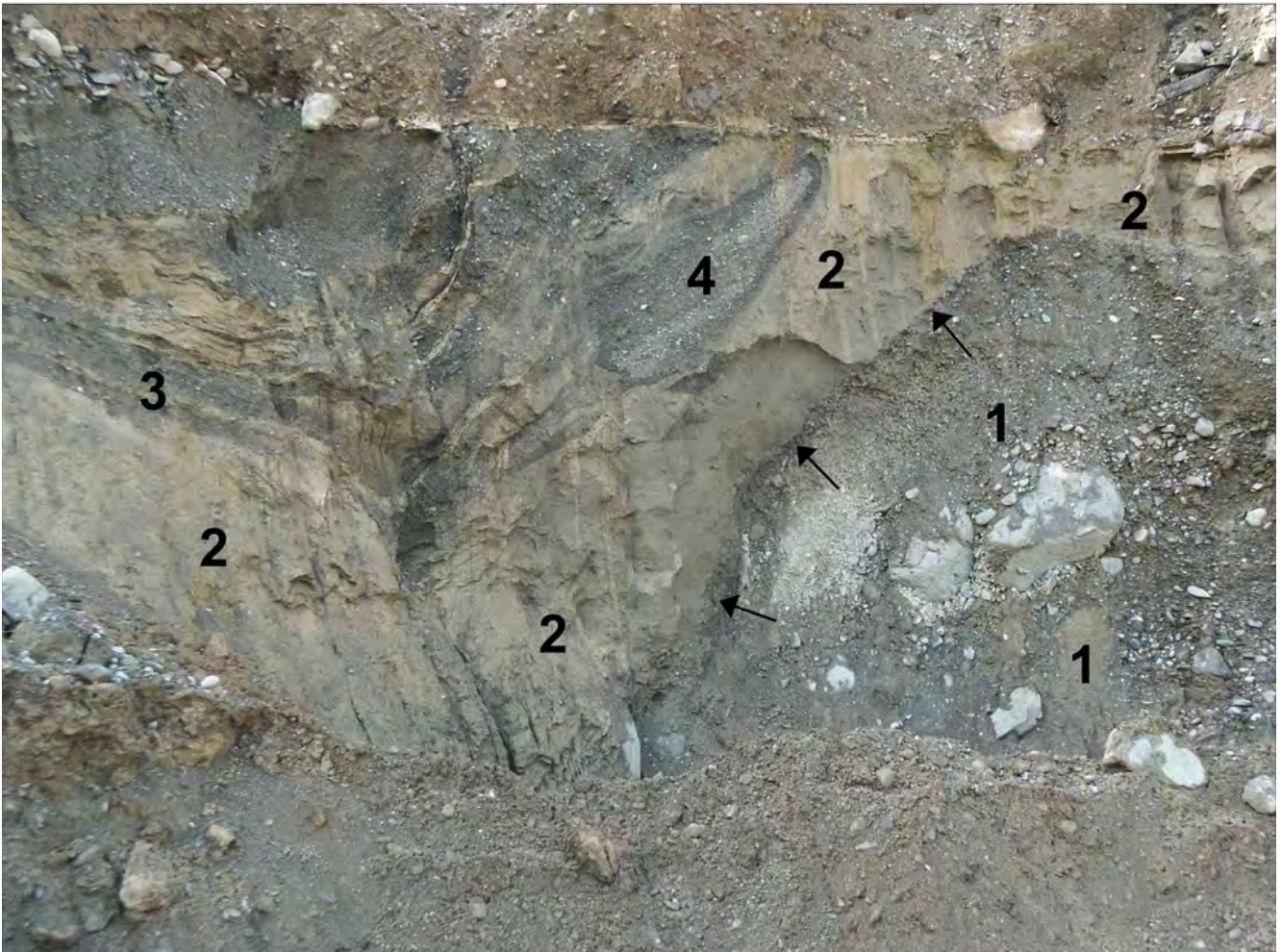
Abb. 3. Kiesgrube südlich Bergl. Völlig unsortierte Kiese mit Blöcken (1) im Liegenden, darüber schluffige Sande (2) mit Kieslagen (3) und einer im gefrorenen Zustand eingelagerter Kiesscholle (4). Trennfläche (Pfeile) mit ca. 55° einfallend. Vertikale Störung in linker Hälfte. Blickrichtung nach SW.
