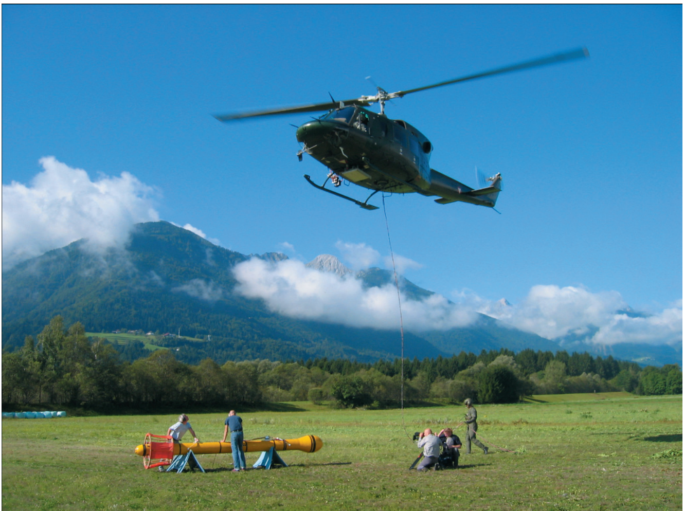
Abb. 1. Der Hubschrauber kurz vor dem Abheben der Messsonde, welche die Messapparaturen der Elektromagnetik und der Magnetik enthält. Die anderen Messsysteme sind direkt im Hubschrauber eingebaut.
