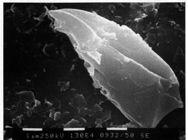
Abb. 11. REM-Fotografie der Feinfraktion „0,5–1,0 μm“ separiert aus einem grau-schwarzen Tonschiefer am Nordrand der unterlagernden Tirolikum-Decke (No. 17, Rauschberg). Große „eckige“ Glimmer bilden eine Kontamination in dieser Fraktion bedingt durch einen Separationsfehler (große Glimmerplättchen lösen sich beim Dekantieren von der Wand der Zentrifugationsflaschen).
