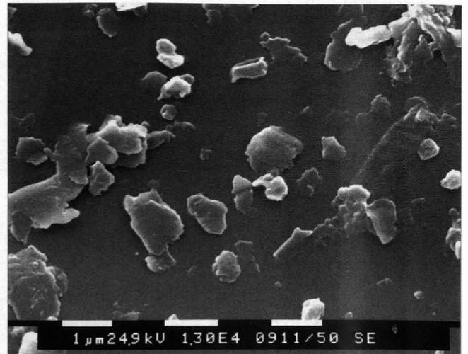
Abb. 10. REM-Fotografien von Feinfraktionen aus Proben des Südrandes der unterlagernden Tirolikum-Decke. „0,5–1,0 μm“-Fraktion separiert aus anchimetamorphem schwarzem Tonschiefer (No. 4, Hochkönig).
