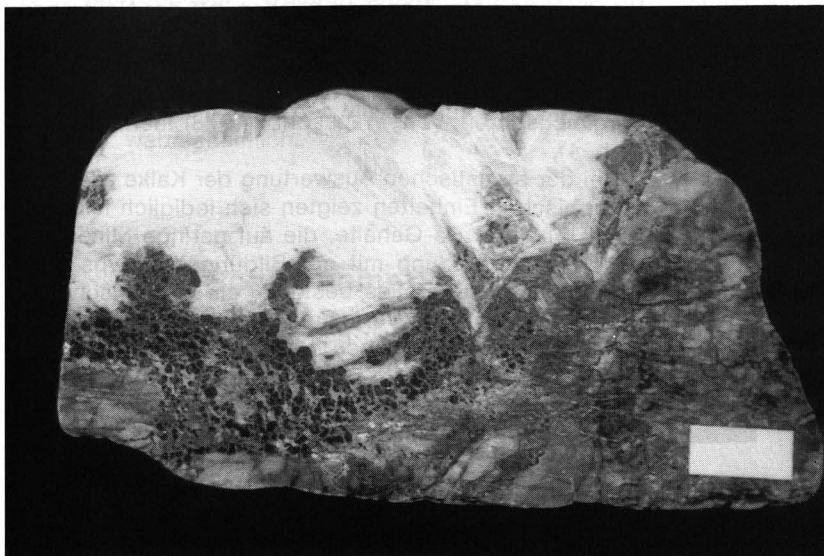
Abb. 6. Spaltenfüllung mit Baryt (weiß) und randlich zum mitteldevonischen Nebengestein Zinkblende (schwarz). Die Mineralisation setzt sich ins Nebengestein an Styolithen fort. Vergrößerung ca. 1,3x.
