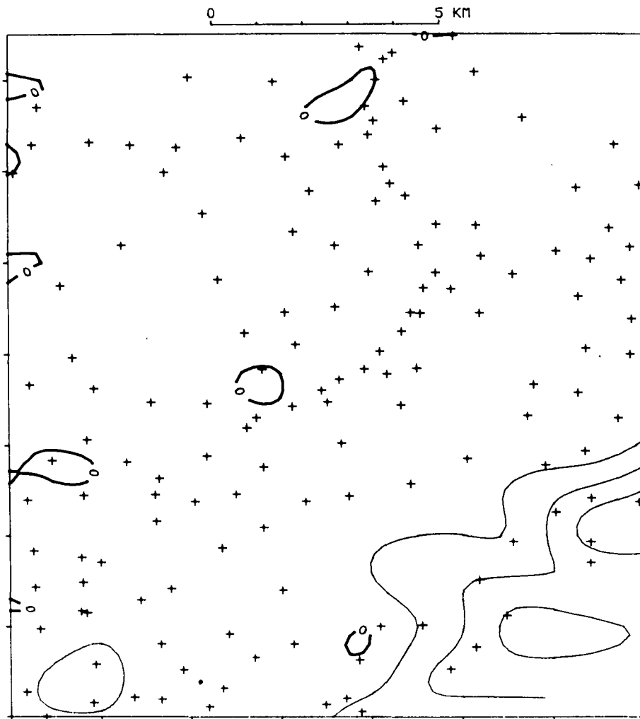
Abb. 9. Differenz zwischen der Standard- und der ausschließlich bezüglich der Talfüllungen geologisch reduzierten Bougueranomalie im Testgebiet. Isolinienintervall : 1 mGal.
