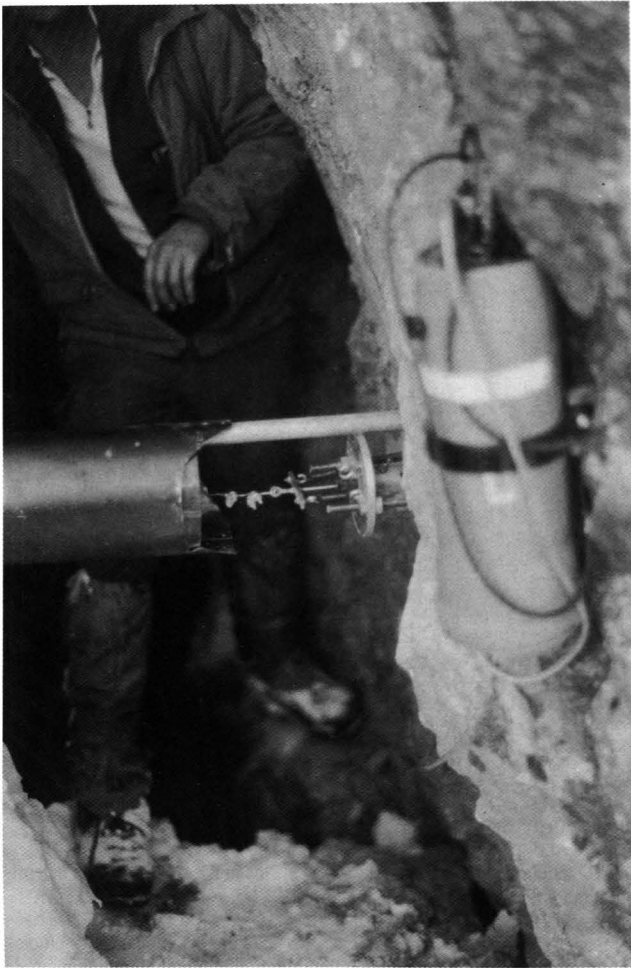
Abb. 8. Detailansicht des Präzisionsextensometers mit dem Datensammler im Vordergrund. S.a. Abb. 4; Detailansicht Präzisionsextensometer..
