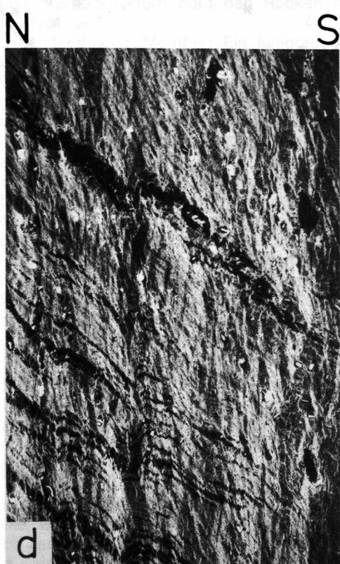
Abb. 7. Gefüge von Gesteinen phyllosilikatreicher „Crinoiden-Schichten“ der Schuppenzone des Rötischgrabens. a) Quarzgefüllter Streckungshof um Erzkorn. Schliff, X-Z-Schnitt, gekreuzte Nicols, lange Bildkante ca. 1,3 mm. b) Drucklösung und westgerichteter Versatz präexistenter Dehnungsgänge (E) längs Schieferungsflächen. Schliff, X-Z-Schnitt, gekreuzte Nicols, lange Bildkante ca. 3,3 mm. c, d) Ausbildung einer Transversalschieferung durch Drucklösung. Diese Falten stehen im Zusammenhang mit dem Antiklinorium der Passailer Gruppe östlich des Weißbecks. c = Handstück, Teilung der Skala: 1 cm; d = Schliffnegativ, lange Bildkante ca. 1,5 cm, Schnitt quer zur Faltenachse.
