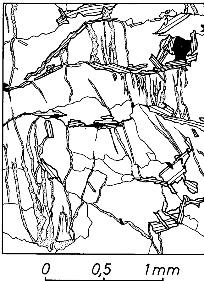
Abb. 6: Hornblende-Biotit-Andesin-Metagranodiorit. Schliff 8334, 1 Nicol; Fundort: Punkt 2438 m am Grat von der Kerl Spitz zum Kalkstein Jöchl. Schieferung parallel kurzer Bildkante. Feldspat-Quarz-Grundmasse = weiß; vollkommene Ausheilung gefiederter Haarrisse der Bruchschieferung durch Laumontit = punktiert; Biotit = fett umrandete weiße Leisten und Tafeln mit Spaltbarkeit; Erz = schwarze Flecken.
