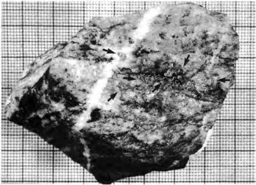
Abb. 15: Goldquarzit-Handstück aus dem Hainzenberg mit anhaftendem Goldblech, besonders von der Mitte nach rechts, auch auf quarzitverheilten Zerrfuge! Siehe Pfeile. Maßstabunterlage: mm-Papier
