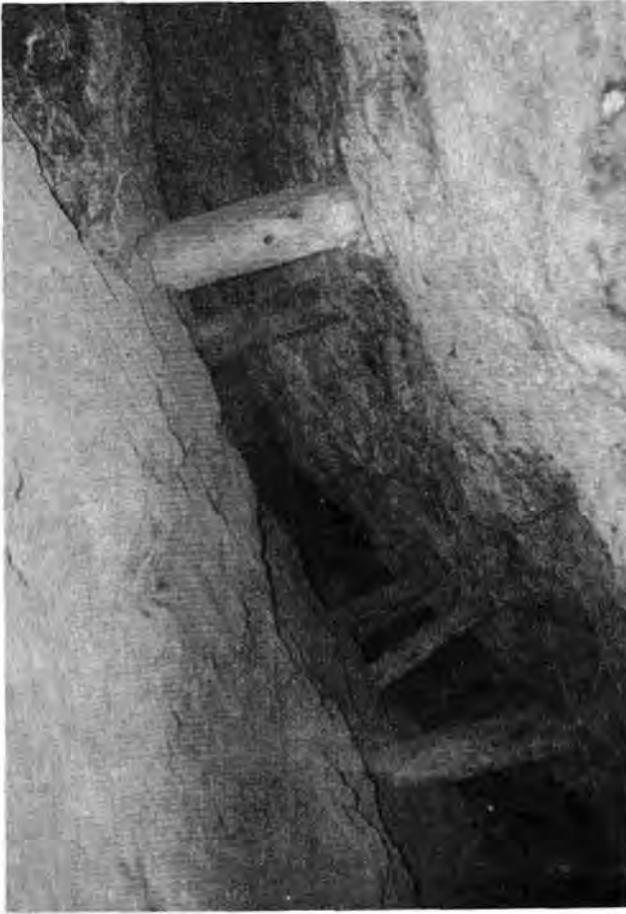
Abb.1: Typisch lagerförmiger Abbau einer steilstehenden Goldquarzitlage. Revier Hainzenberg. Aufn. H. WENGER, 1980.
