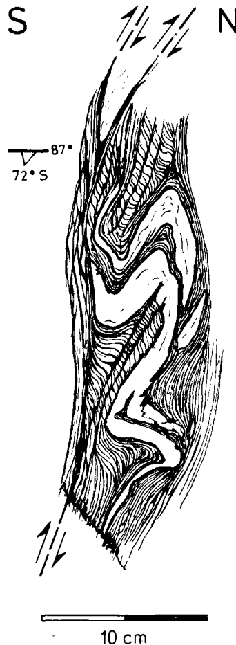
Abb. 69: Faltung mit Schieferungsscherklüftung (Deformation (2)) in Quarzphylliten (mit Quarzlinsen) am W-Rand des Walchaumesozoikums. – Autobahnanschnitt SW' Steinfeldgut. – Struktur Nr. 46, Lage s. Tafel 6.
