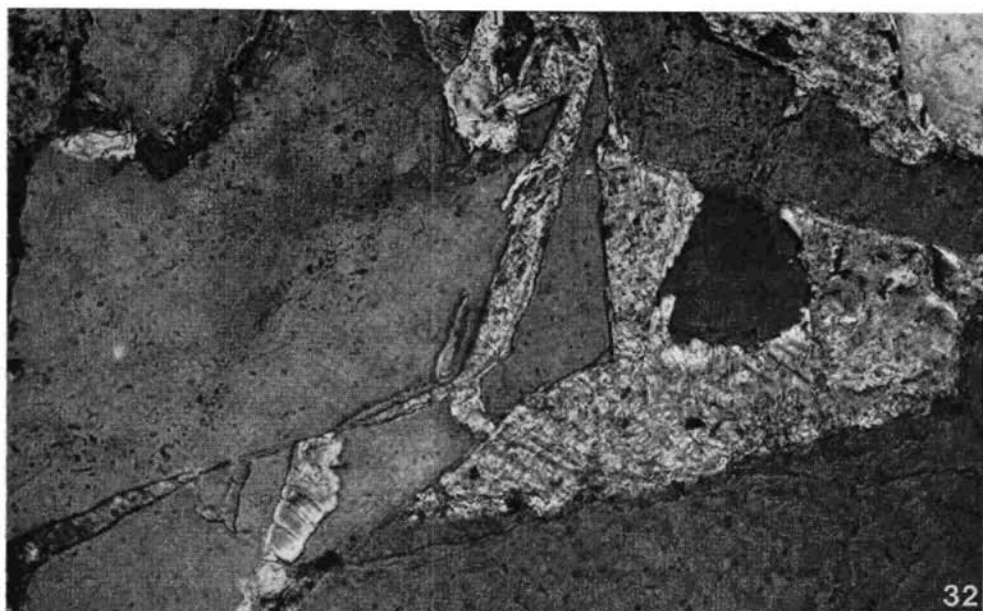
Abb. 32: Diagenese. Calcit-Zement (hell) korrodiert Quarzkomponenten, dringt in Kornrisse ein und zersprengt die Körner. Arkose des marinen Bereiches der Grestener Schichten. — Forststraße S Hoisn am Traunsee (254/2). Schräge Nicols, 150× vergrößert.
