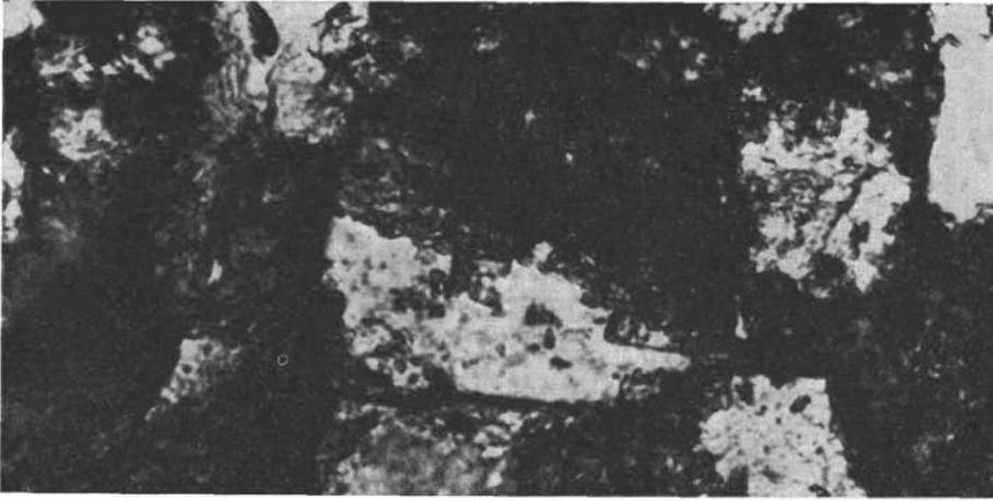
Abb. 11: Diagenetische Kornveränderung an Feldspat, Probe Nr. 221/27 — Jauken-Süd, Liegendteil des 2. Schiefers, Dünnschliff-Photo, Vergrößerung 300fach. Das Feldspatkorn in der Bildmitte wird randlich von karbonatischem Material verdrängt, das auch bereits das Korn zu durchdringen beginnt. Der hellere Saum um das Korn entspricht der ursprünglichen Korngröße.
