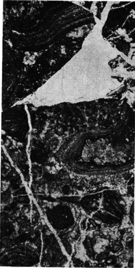
Abb. 7: Oberster Wettersteinkalk mit Pisolithen, Probe Nr. 144/18 — Mežica (Mieß) — Stollenaufschluß, Dünnschliff-Photo, Vergrößerung 80fach.
