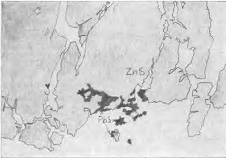
Abb. 36: Kataklastische Zinkblende (ZnS), etwas Bleiglanz (PbS) in Flußspatgangart. 72× vergr.
