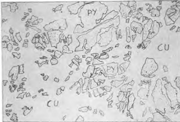
Abb. 3: Pyrit stark kataklastisch, jedoch nicht eingeregelt; Klüfte von Kupferkies ausgeheilt. Vergrößerung 72×
