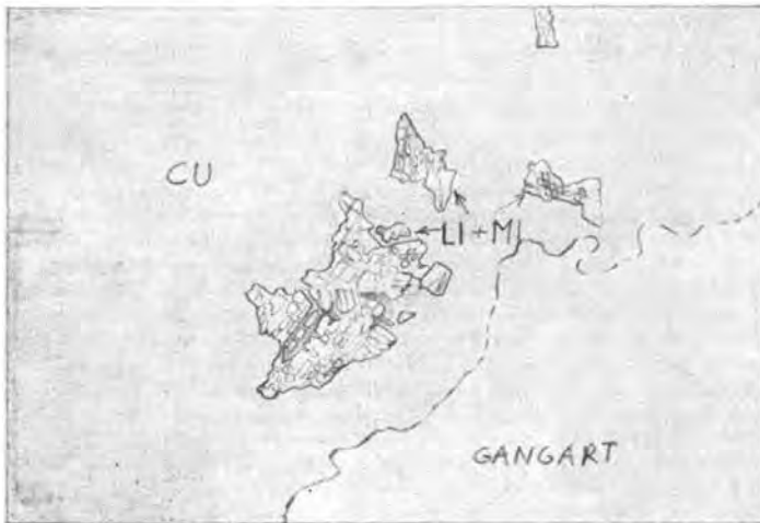
Abb. 9: Linneit (Kobaltkies) (LI), von Kupferkies (CU) und Millerit durchwachsen. // Nic., 72× vergr.
