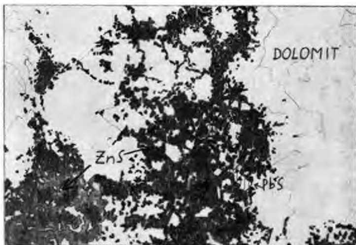
Abb. 10: Zinkblende und Bleiglanz verdrängen körnigen Dolomit. // 72× vergr.
