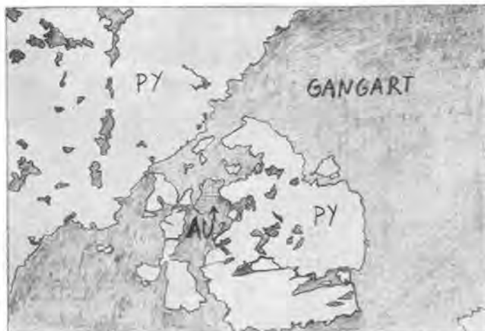
Abb. 22: Kataklastischer Pyrit (PY) mit Freigold (AU). 144× vergr.
