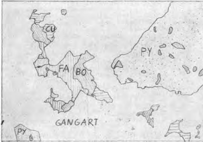
Abb. 8: Pyrit (PY) mit Bornit (BO) gespickt, Fahlerz (FA), Bornit und Kupferkies (CU) eng miteinander verwachsen. // Nic., 72× vergr.
