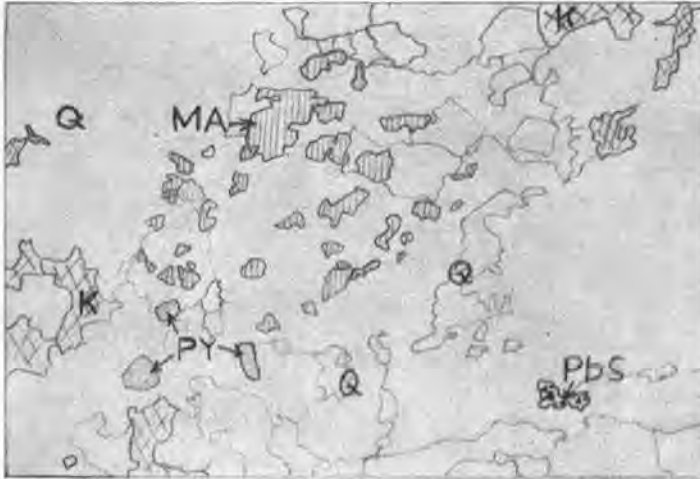
Abb. 31: Magnetitkorn (MA), von Gangart angelaut und aufgelöst, in Gangart von Quarz (Q) und Karbonat (K), mit granoblastischem Gefüge. Neu bilden sich kleine Körner von idiomorphem Pyrit (PY) und etwas Bleiglanz (PbS). 72× vergr.
