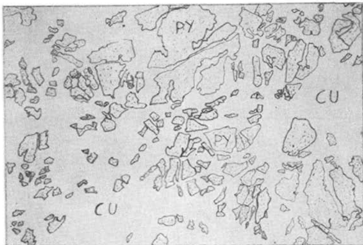
Abb. 3: Pyrit stark kataklastisch, jedoch nicht eingeregelt; Klüfte von Kupferkies ausgeheilt. Vergrößerung 72x
