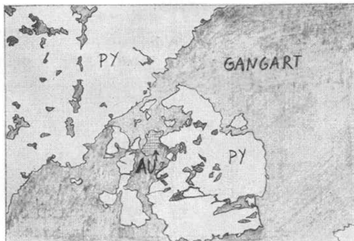
Abb. 22: Kataklastischer Pyrit (PY) mit Freigold (AU). 144× vergr.
