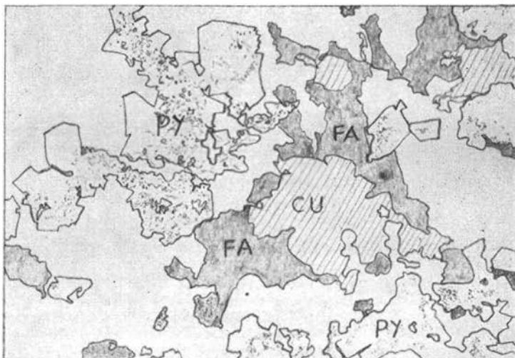
Abb. 23: Kupferkies (CU) verwachsen mit Fahlerz (FA) und Pyrit (PY), letzterer z. T. mit schaumig-porösen Gelpyritstrukturen. 72× vergr.
