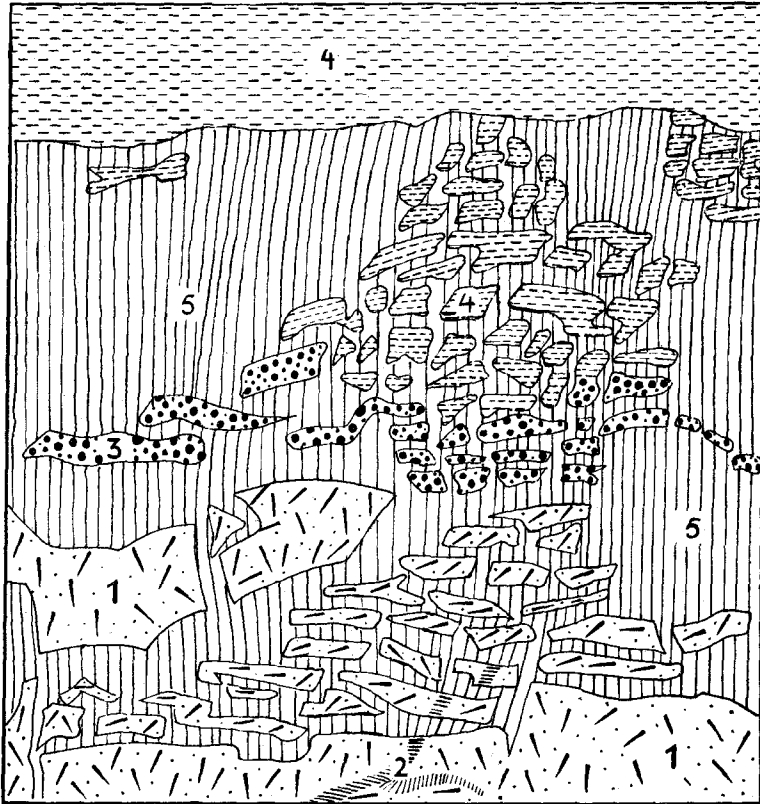
Abb. 3: Obere Melaphyrgrenze im Posanner-Ankehrschurf. 1 = Melaphyr, 2 = Chlorit, 3 = gefritteter Ton, 4 = grüner Ton, 5 = Faseranhydrit. Zirka 1:1.
