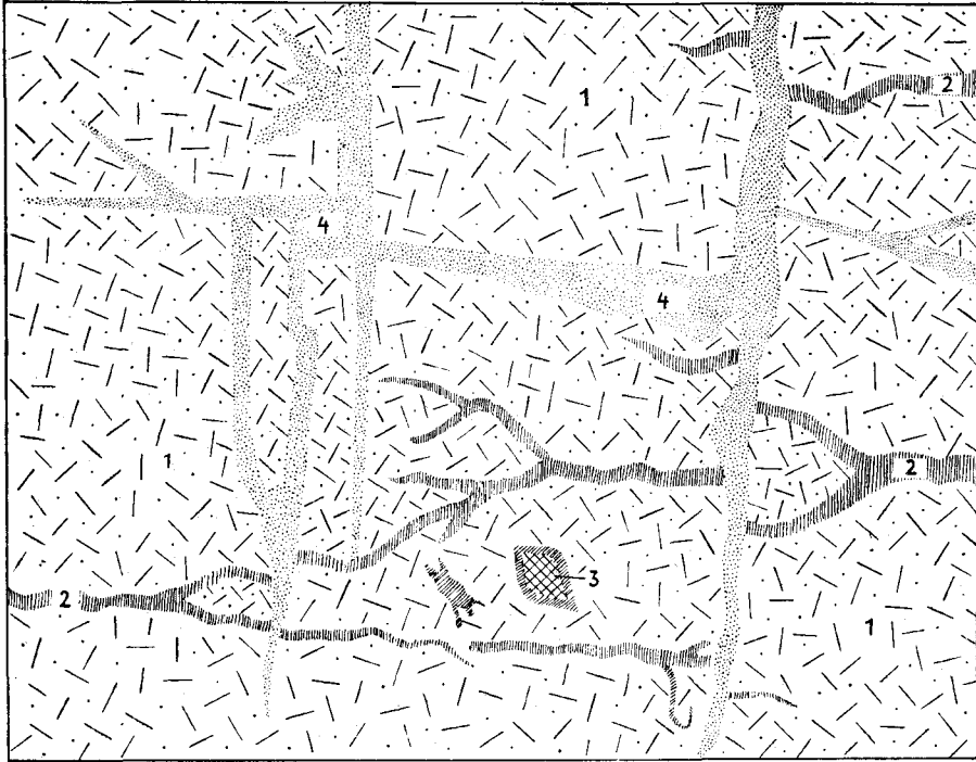
Abb. 2: Verteilung der älteren und jüngeren Klüfte im Melaphyr. 1 = Melaphyr, 2 = Chlorit, 3 = Steinsalz, 4 = körniges Steinsalz. \frac{2}{3} der natürlichen Größe.
