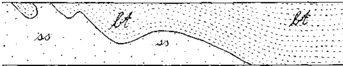
Abb. 5. Detail aus einem Schützengraben westlich des Annaberges (= \odot 267,8). ss = Steinitzer Sandstein, bt = bunte (rote und graue) Tone der Niemtschitzer Schichten mit Eisen-Mangan-Konkretionen. Die Kontaktfläche der beiden Gesteine dürfte eine tektonische sein. Länge des Aufschlusses in der Natur 8 m.
