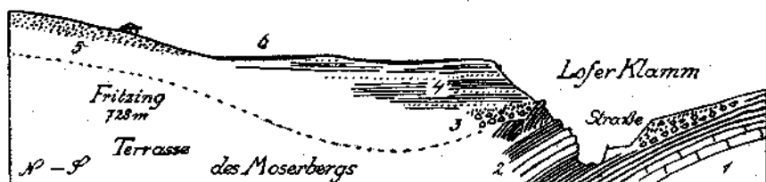
Fig. 13. 1 = Plattenkalk. 2 = Kössener Schichten. 3 = Grundmoräne mit vielen Trümmern des Untergrundes. 4 = Lehm, Sand und Schotter mehrfach wechselnd. 5 = Hangende mächtige, stark bearbeitete Grundmoräne. 6 = Torfmoor.
