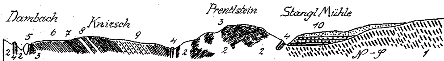
Fig. 16. 1 = Buntsandstein. 2 = Werfener Schichten und Haselgebirge. 3 = Rauhwacken und Dolomitmylonit. 4 = Gutensteiner Kalke. 5 = Wettersteinkalk? 6 graue, milde Mergel (Gosauschichten). 7 = ölgrüne Sandsteine mit Kohlenstückchen, viel Glimmer, ziemlich grobkörnig (Gosauschichten). 8 = dickbankige, milde, graue Mergel bilden quer zur Schichtung Abhäutungen und wechsellagern mit dünn-schichtigen dunkelgrauen Mergeln mit Pflanzenresten (Gosauschichten). 9 = Lagen mit exotischen Geröllen (Gosauschichten). 10 = unten grobes Konglomerat und Bänderton, darüber mächtige bunte Grundmoräne.
