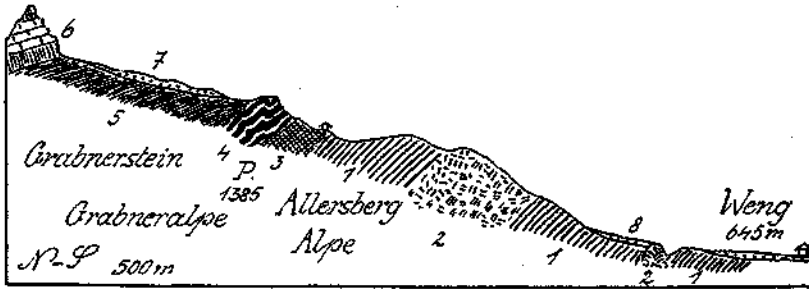
Fig. 9. 1 = Buntsandstein. 2 = Rauhacken. 3 = Unterer Dolomit. 4 = bituminöse, wohlgeschichtete Gutensteiner Kalke. 5 = Anhäufung von Lunzer Sandsteinen. 6 = Kalk- und Dolomitlagen wechselnd — Dachsteinkalk. 7 = Lokalmoräne. 8 = Hangschutt.
