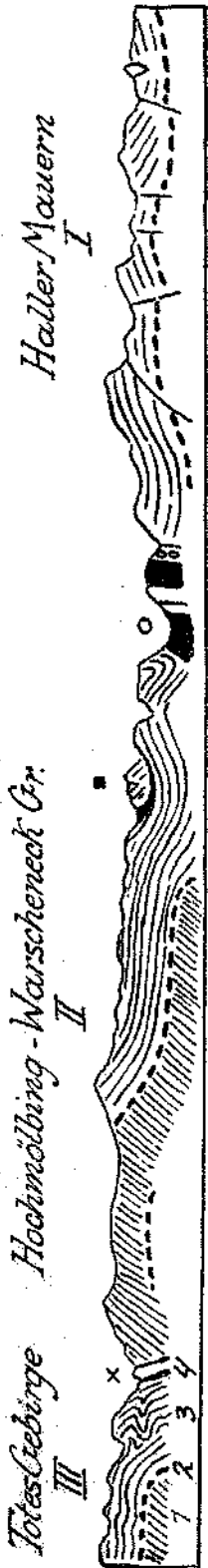
Fig. 22. Ostwestprofil durch die drei getrennten Schuhmassen von Haller Mauern I — Warscheneckgruppe II — Totes Gebirge III. 1 = Unterer Dolomit, Wettersteinkalk. 2 = Raibler Schichten. 3 = Dachsteindolomit und -kalk. 4 = Gosauschichten. o = Zusammenstoßstelle von I und II, vgl. Fig. 23. x = Zusammenstoßstelle von II und III, vgl. Fig. 24. ε = Deckschuhmasse des Wurzenzer Kampfs.
