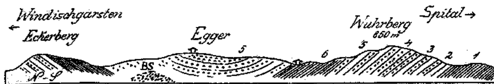
Fig. 17. 1 = graue, feinschichtige, bröckelig zerfallende Mergel. 2 = Mergel mit exotischen Geröllen, Verrucano, Porphyre ... 3 = feinkörnige Sandsteine. 4 = festere Sandsteine mit Lagen von bunten exotischen Geröllen. 5 = reiche exotische Geröllführung. 6 = weiche schiefrige Mergel. Auf dem Kamm des Eggerbauerhofes liegen überaus viele bunte exotische Gerölle manchmal bis Kopfgröße. Es ist wahrscheinlich, daß diese sehr harten und zähen Gerölle als Material für prähistorische Werkzeuge verwendet wurden. BS = Buntsandstein.
