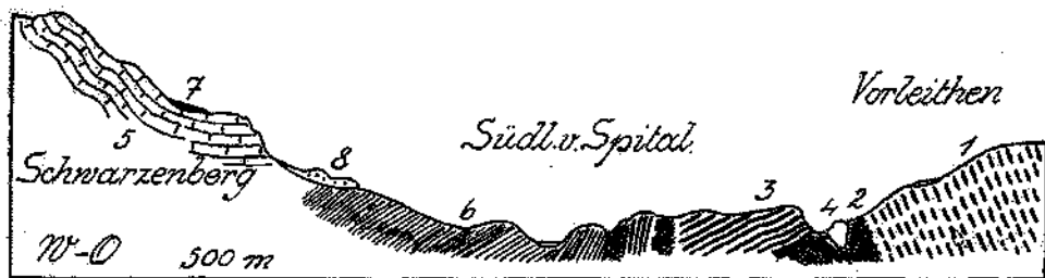
Fig. 18. 1 = Buntsandstein. 2 = Haselgebirge und Rauhwacke. 3 = Gutensteiner Kalke. 4 = Wettersteinkalk. 5 = Dachsteinkalk. 6 = Gosauergel und Sandsteine, grüngrau, mild, feines Material. 7 = Gosaubreccie, rotzementiert, lokale Bildung.
