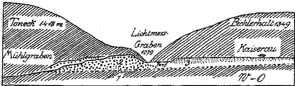
Fig. 20. 1 = Grundgebirge — Grauwackenzone. 2 = Seitenmoräne des Enns-Paltengletschers. 3 = kalkalpiner Schuttkegel.
