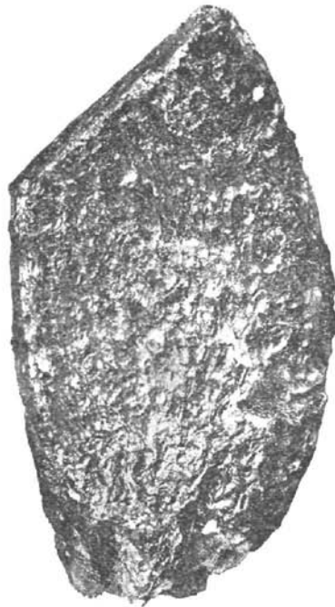
Convexe Seite der zersprungenen Scheibe mit Anzeichen von Aufschmelzung. Beisp. 34, Taf. VI, Fig. 7. Vergrößerung: \frac{5}{3} .
