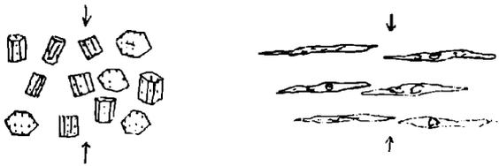
Die sechsseitigen Prismen in a sind die ursprünglichen (idiomorphen) Biotitsäulen, die durch den in der Richtung der Pfeile wirkenden Druck derartig deformirt wurden, dass in dieser Richtung die Lösung der Biotitsubstanz eintrat, in der dazu senkrechten Richtung neuerliche Krystallisation erfolgte: Bildung der breiten Biotitblätter.
