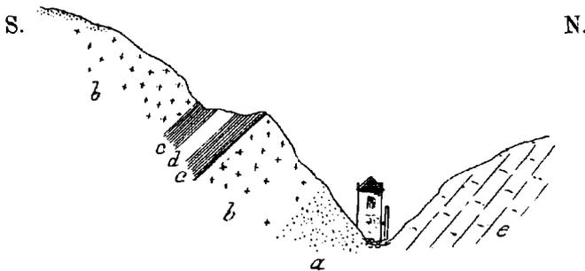
a Gehängeschutt. — b Diabas. — c Granat-Kalksilicathornfels. — d Krystallinischer Kalk. — e Muschelkalk.
