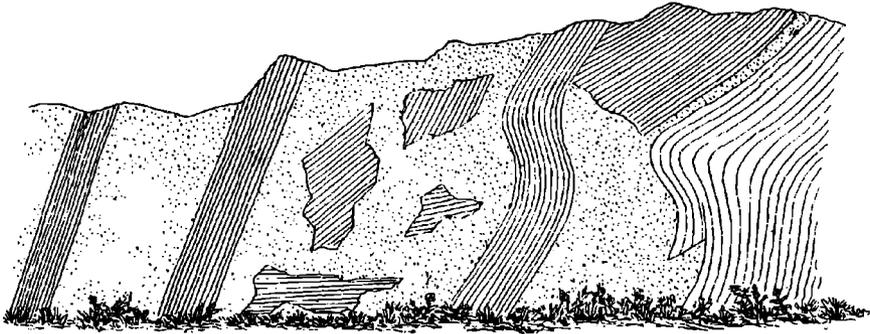
Im Schiefer (Schieferhornfels) stecken Lagergänge von lichtem Ganggranitit. In dem Granitteil eingebettet liegen grosse eckige Stücke von Schieferhornfels. Die Schieferung verläuft in der durch die Schraffen angegebene Richtung.
