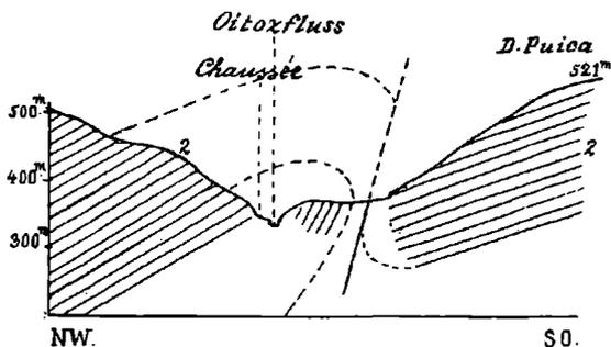
Profil Fig. 13 und Fig. 14 verqueren eine und dieselbe Antiklinale in einem gegenseitigen Abstände von etwa  $\frac{1}{4}$  Kilometer.
