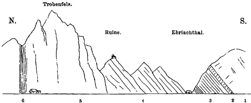
1 Grün-schiefer. — 2 Rother Sandstein (Grödener Sandstein). — 3 Werfener Schiefer mit Zopfplatten. — 4 Kalk und Dolomit der unteren Trias. — 5 Erzführender Kalk. — 6 Carditaschichten.
