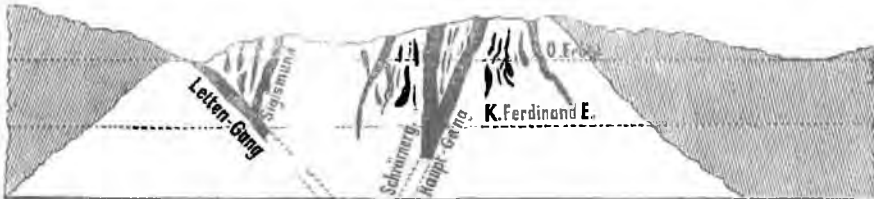
Fig. 5. Querprofil durch Ludovica- und Michaelischacht.
