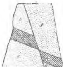
a. Kohlenflötz. b. Sandstein. c. d. Verwerfungskluft.
