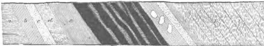
a Mergel. b Dunkelbraune Schieferthonschichte. c Feinkörnige Sandstein-Schichte. d Feinlätteriger Pflanzenführender Schiefer. f Kohlenflötz mit den Zwischenmitteln g. h Schiefer mit Thoneisenstein-Knuern. i Sandstein. k Verwitterte schwarze Schiefer. l Flecken-Mergelkalk.
