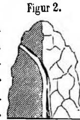
Die in linsenförmigen Ausscheidungen auftretenden Erze bestehen aus oktaedrischem Kobalt mit Gehalt an Wismuth, Nickel, Arsenikschwärzen, Bleiglanz. Der Gang ist noch mit aufgelöstem Porphyr und Schiefer, Quarz und Letten ausgefüllt und scharf von dem Nebengestein geschieden. Dieser Erzpunct befindet sich im Liegenden einer übersetzenden Kluft.
