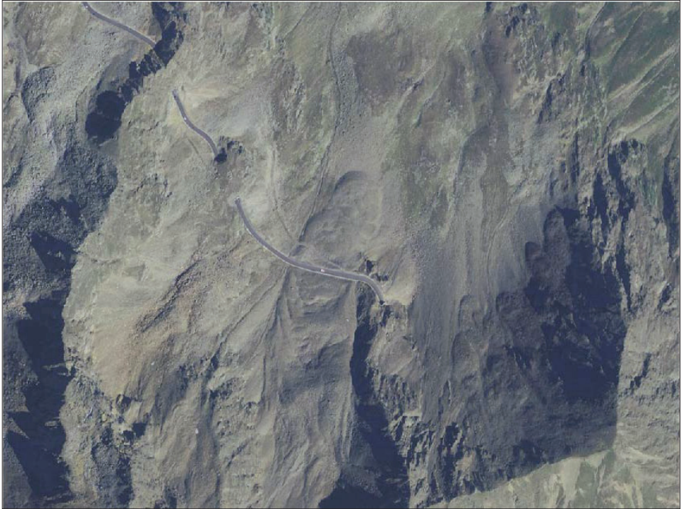
Abb. 18: Beispiel für einen Straßenabschnitt im Permafrost. Das Bild zeigt den oberen Bereich der Straße auf das Timmelsjoch, die Linienführung der Straße quert einen aktiven Blockgletscher.
