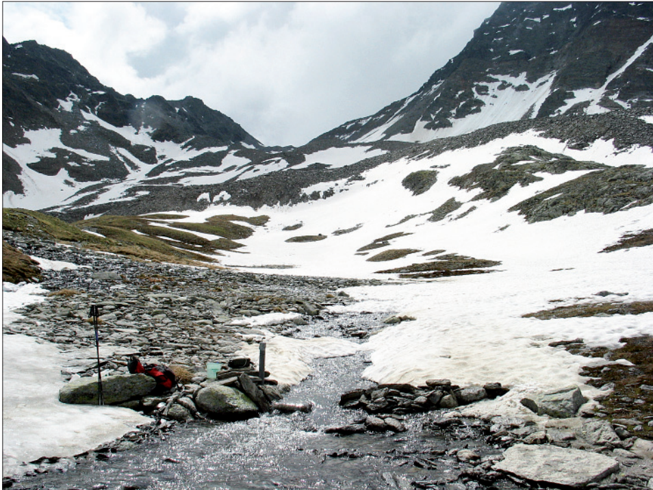
Abb. 46: Pegelmessstelle im Vorfeld des Blockgletschers Napfen. Der Pegel erfasst ca. 80 % des Gesamtabflusses des östlichen Teiles des Blockgletschers Napfen.
