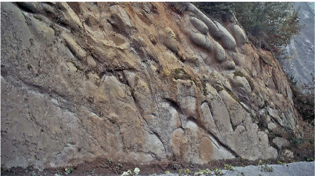
Abb. 4.5: Kluffläche mit Verwitterungszone im Granodiorit mit Übergang vom unverwitterten Zustand bis zur typischen Wollsackverwitterung. Steinbruchwand im Steinbruch Gehrenberg, Heppenheim-Sonderbach, Fa. Röhrig Granit – © Guido Vero
