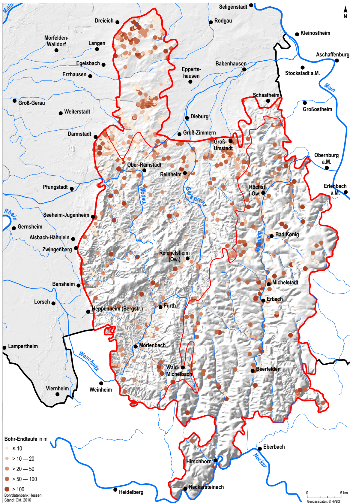
Abb. 5.14: Vorhandene Bohrungen mit Teufeninformation im Kristallinen Odenwald, im Buntsandstein-Odenwald und im Sprendlinger Horst (Teufe in m; Bohrdatenbank Stand Oktober 2016)
