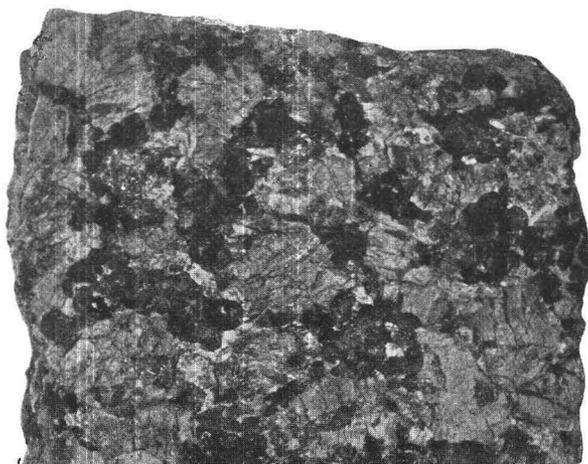
Fig. 21. Granit von der Insel Jungfrun (Analyse 78) im Kalmarsund. Autotypie von einem Handstück. Die idiomorphen tief rauchgefärbten Quarzkörner erscheinen schwarz und die roten Feldspate grau. Nat. Grösse.
