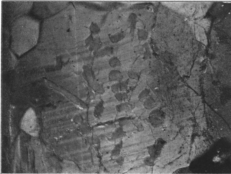
Fig. 8. *Oligoklasmikroperthit* im Warberggranit. Die Zwillingsbildung des Oligoklases ist sichtbar. Vergr. 200: 1. Nic. gekr.
