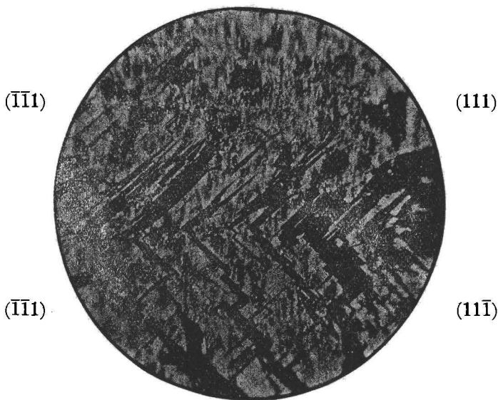
Fig. 9. Lamellierung beim Knopit, Schliff \parallel (110) . Reflektirtes Licht.
