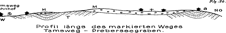
Fig. 36 b. Profil längs des markierten Weges Tamaweg - Prebersee-Graben. Bei a erfolgt die Abstieg in diesen Graben. T = unter-miozäne Konglomerate, Sande, Letten. M = eiszeitliche Moräne. Das Untermiozän ist schief gestellt und teilweise abgetragen und z. T. von der aufgelagerten Moräne verhüllt.
