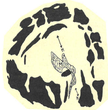
Abb. 2. Schwarz = Kalzit; weiß = Quarzkörnerhaufwerk; M = Muskowit. H—H = Halbierende der Falte. (Dünnschliffbild vergrößert.)
