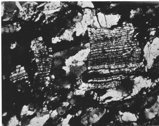
Abb. 1: Kataklastischer Gneisgranit, Gr. 50 (Gerölle). Albit, ungefüllt mit Albitlamellen, auch Spaltung sichtbar, hochgradig deformiert, zerissen, Risse mit Quarzgewebe verheilt. Vergr.: 48fach.
