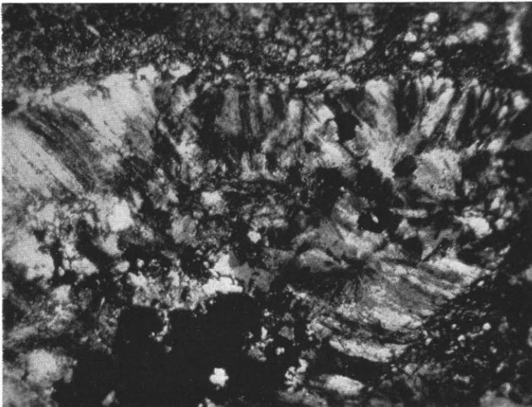
Abb. 4: Schwarzbrauner, mikrogranitischer Quarzporphyr (Gerölle) von LaBnitzhöhe bei Graz (GRIESSL 12). Felsitkörper in mikrogranitischer Grundmasse, Beachte den wandständig-faserigen Bau. Vergr.=48fach.
