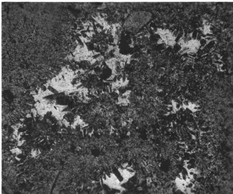
Abb. 1: Violettbrauner, mikrogranitischer Quarzporphyr (Gerölle) von Laßnitzhöhe bei Graz (GRIESSL 54). Grobgranophyr: Hell = Quarz, darin dunkel = Feldspatkriställchen, grau = mikrogranitische Grundmasse. Vergr. = 60fach.
