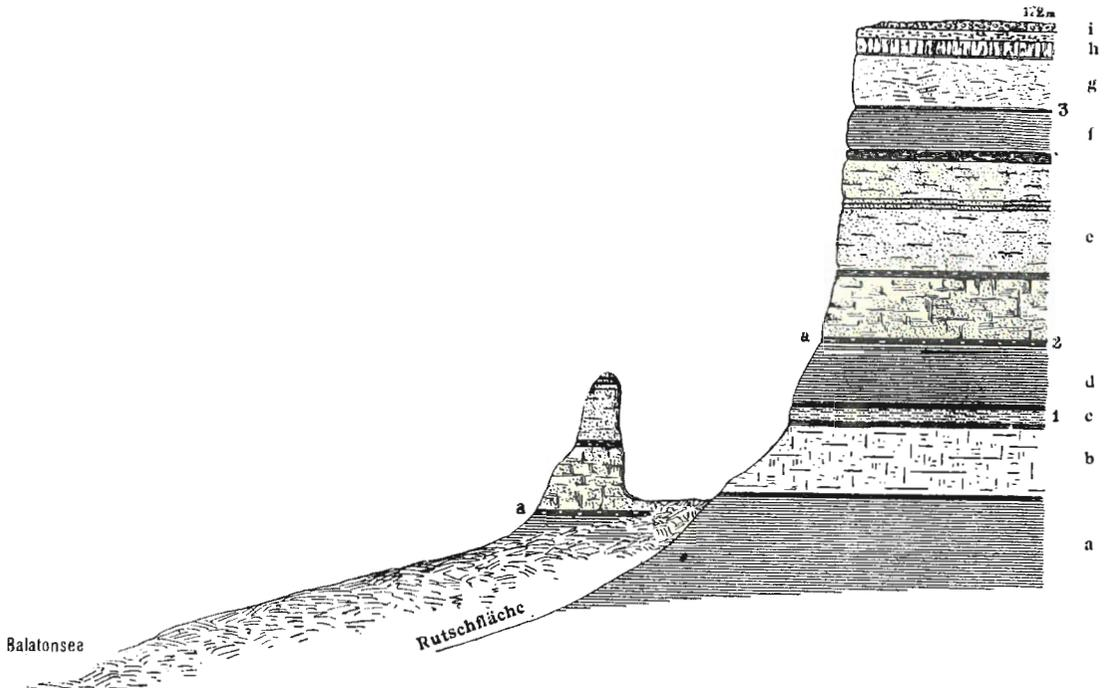
Fig. 4. Profil der Fancséröldal von Keszthely. Masstab 1:1000.
