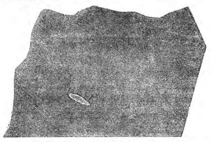
An dem hiermit beigefügten Abdruck der schwächer geätzten Seite wird man leicht die Lage der Linien erkennen. Die lichteren Gegenden sind durch eingewachsenen Schwefelkies hervorgebracht, welcher durch die Säuren weggeätzt wurde.
