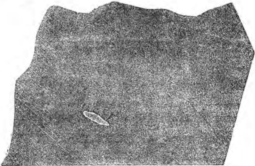
An dem hiermit beigelegten Abdruck der schwächer geätzten Seite wird man leicht die Lage der Linien erkennen. Die lichterem Gegenden sind durch eingewachsenen Schwefelkies hervorgebracht, welcher durch die Säuren weggeätzt wurde.
