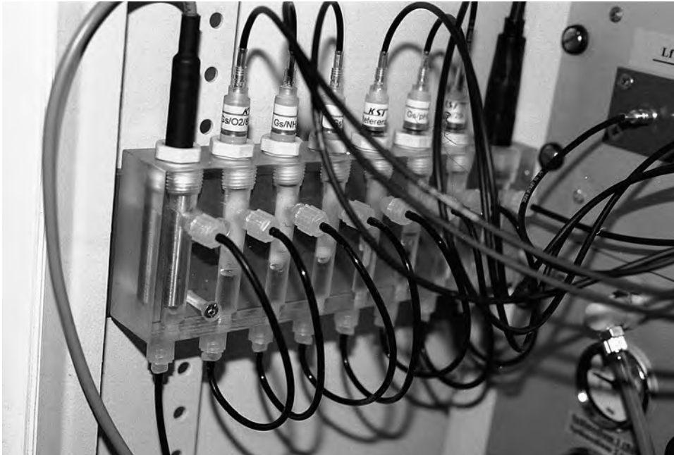
Fig. 12.9: Detail des Gerätesystems SAMSON. Automatische Durchflussmesszelle zur Bestimmung von pH-Wert, LF, Eh, Sauerstoffgehalt, Temperatur, Ammonium- und Nitratgehalt. Detail of the SAMSON system: automatic flowmeter cell to determine the pH, conductivity, Eh, oxygen level, temperature, ammonium and nitrate content.
