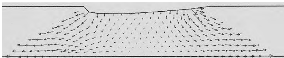
Fig. 7.3: Lateral dominierte Flussbettinfiltration. Lateral infiltration gradients.
