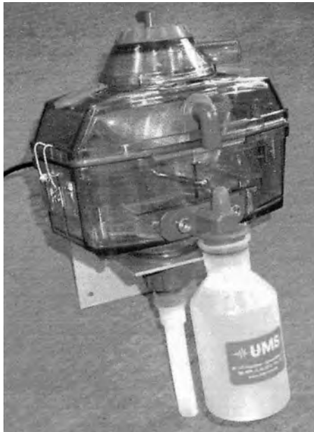
Fig. 13.5: Kippzähler. Tipping counter.
