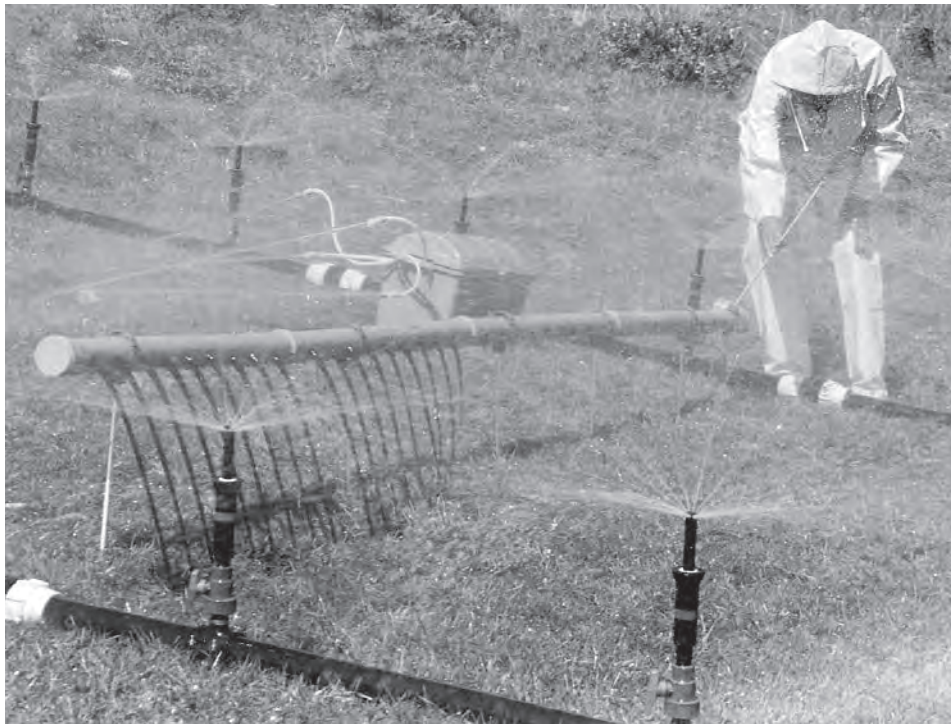
Fig. 40: Schwenkvorrichtung zum Auftragen des Markierungsstoffes nach G. MARKART & B. KOHL (1995). Mechanism for pivoting for spreading the tracer after G. MARKART & B. KOHL (1995).
