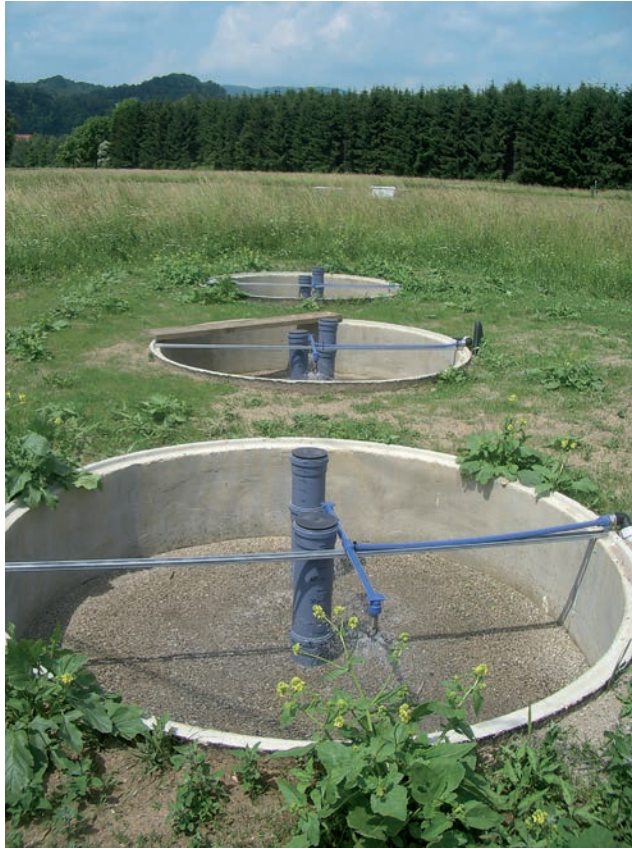
Fig. 1: Versuchsbecken zur Untersuchung der Versickerungs- und Reinigungsleistung in Andritz. Experimental basins to investigate infiltration and retention rate in Andritz.
