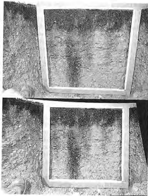
Fig. 4.14: Original and geometrically corrected image of a soil profile ( 1 \times 1 m). Originalbild und geometrisch entzerrtes Bild eines Bodenprofils ( 1 \times 1 m).
