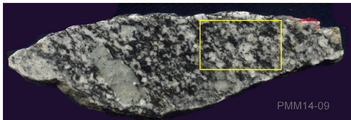
Abbildung 13: Handstück eines schwach deformierten Orthogneises (aus WBG).
