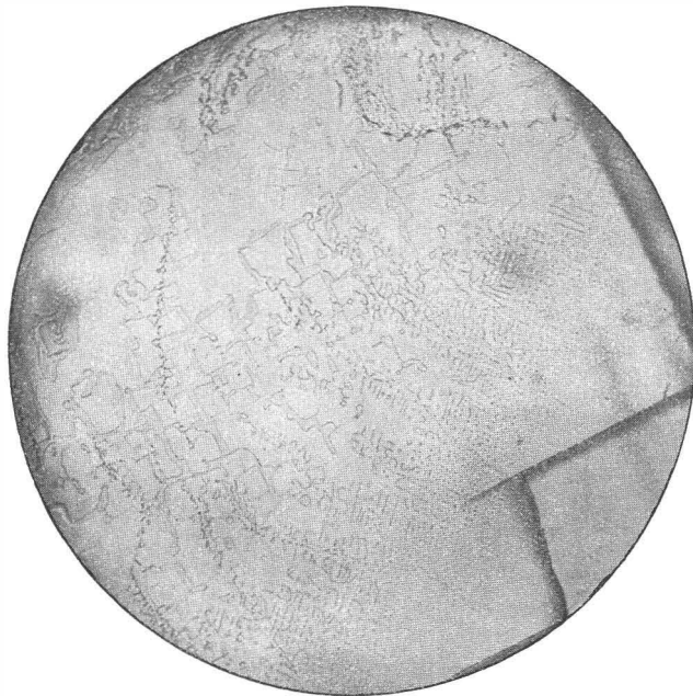
Einschlüsse von Gas und Lauge, die Hohlräume nach Würfel- und Rhombendodekaederfläche langgestreckt, oder danach reihig angeordnet.
