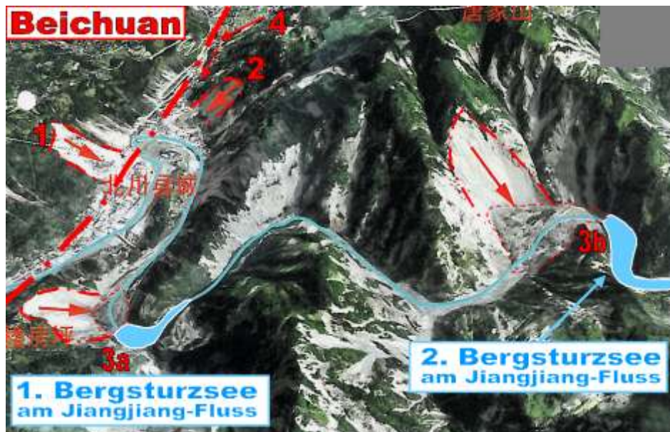
Abb. 5: Ein digitales Höhenmodell der Gegend um Qushan in Beichuan zeigt die Fülle an katastrophalen Ereignissen, die zur völligen Unbewohnbarkeit der ehemaligen Bezirksstadt geführt haben: 1 = Felslawine zerstört Ortsteil um die Mittelschule; 2 = Rutschung zerstört 30 6-stöckige Häuser; 3 = der Baiguoshu-Bergsturzsee (a) und der zuletzt 20km lange Tangjiashan-Bergsturzsee (b) mit einem Volumen von 240 Millionen m 3 brechen aus und überschwemmen die bereits evakuierte Stadt; 4 = eine Mure verwüstet den Südteil der Stadt.
