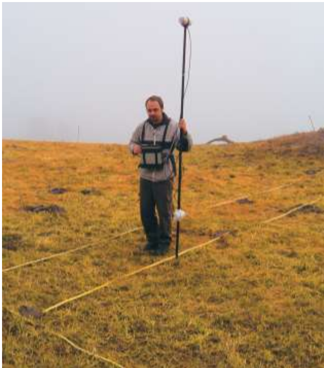
Abb. 4: Magnetik Feldmessungen – zwei Magnetfeldsensoren montiert auf einer Stange
