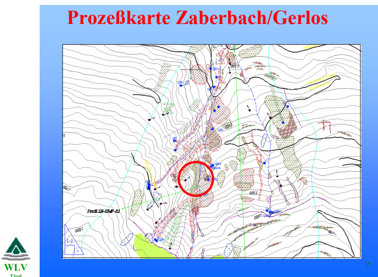
Abb. 7: In der vorliegenden Prozesskarte werden auf Basis des vorhandenen Geoinventars die zu erwartenden Erosions- bzw. Umlagerungsprozesse dargestellt. Der rote Kreis markiert den in nachfolgender Abbildung 8 dargestellten Bruchkesselbereich.
