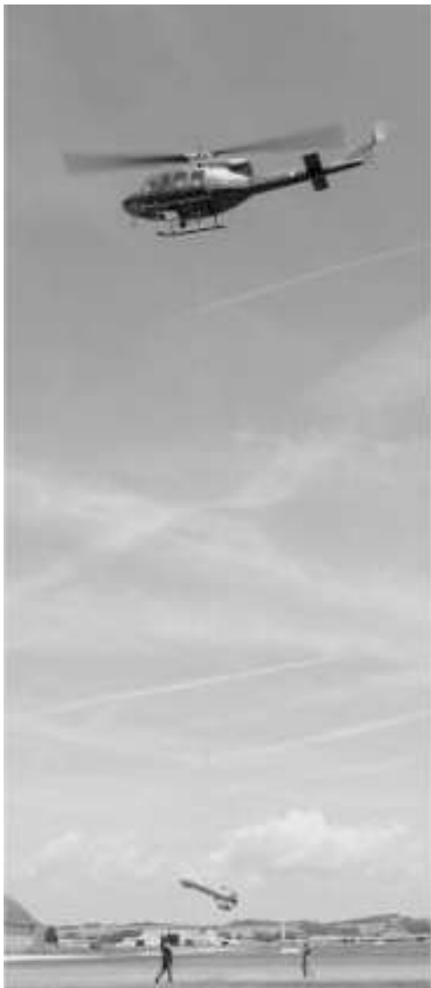
Abb. 3: Hubschrauber und Messsonde der österreichischen Aerogeophysik
