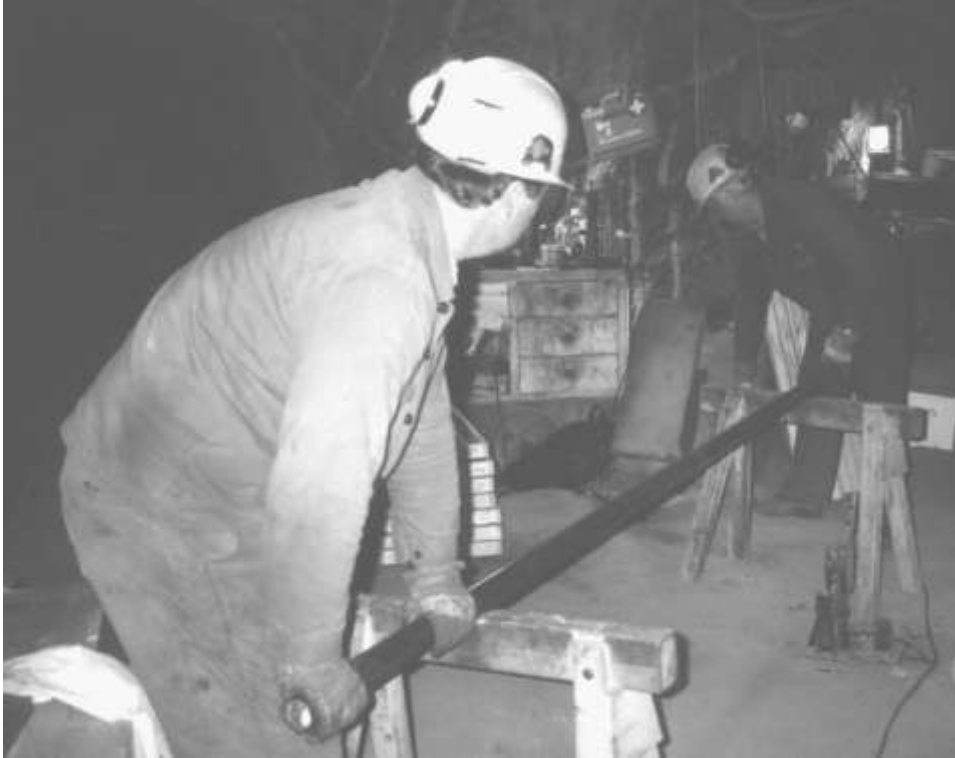
Abb. 1: Tiefenbohrung im alpinen Steinsalz. Gewinnung von Bohrkernen mit 5 cm Durchmesser, vor der Entnahme aus der metallischen Bohrhülse.
