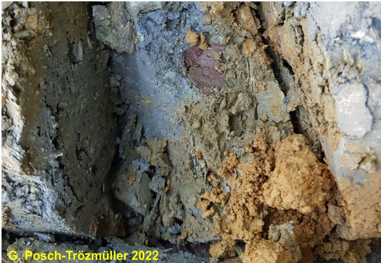
Abb. 1.12.: Beispiel der KB Vereinsweg (2022) in 5,8 m Tiefe (Posch-Trözmüller, 2024): rotvioletter Tonsteinklast in blaugrauem Ton. Dieser Abschnitt der Bohrung wurde als typisch ausgebildetes Permoskyth interpretiert.
