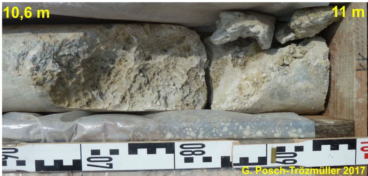
Abb. 1.8.: Detail einer Kernbohrung in Weissenbach (KB-WB-1/17, Posch-Trözmüller et al., 2018): Lösungserscheinungen in festem Kern aus brekziösem Haselgebirge mit Gips zwischen 10,6 und 10,95 m.
