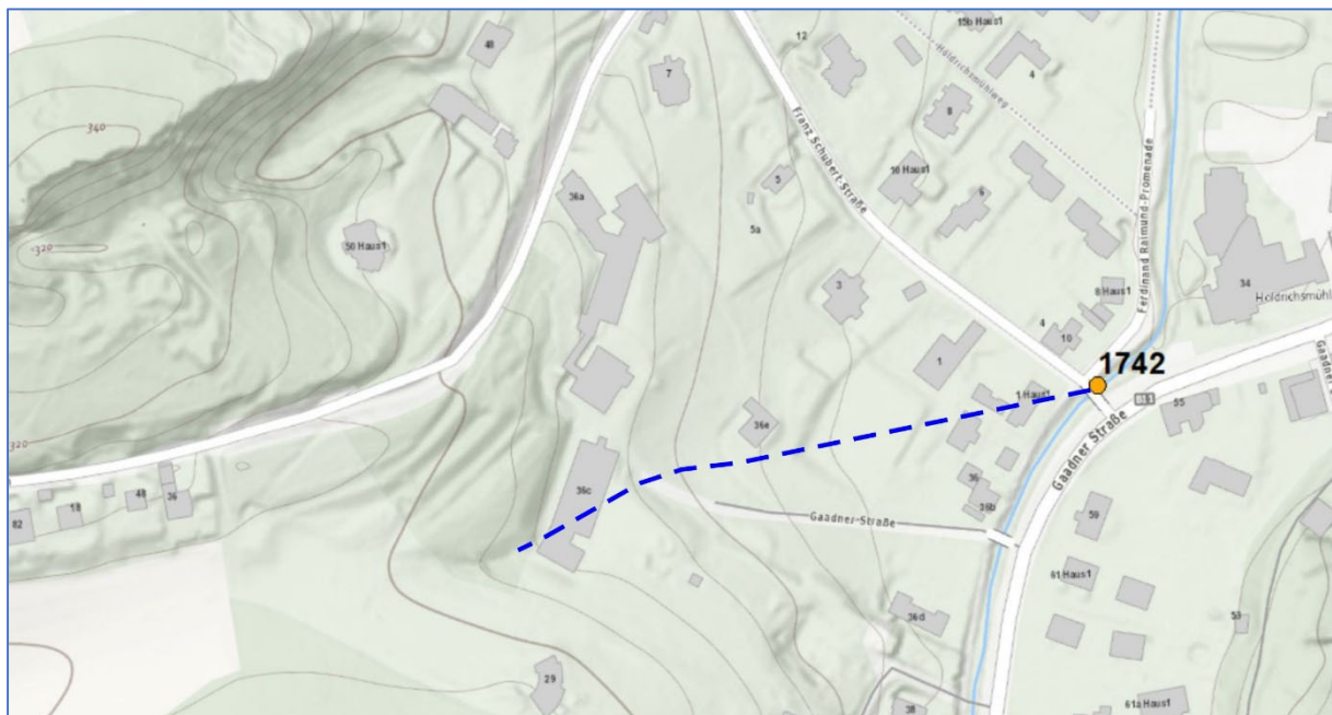
Abb. 4.20.: Vermutliche Herkunft des Wassers, welches aus einem Rohr auf der N-Seite der Mödling einmündet. Die Zahl „1742“ gibt die Leitfähigkeit an.
