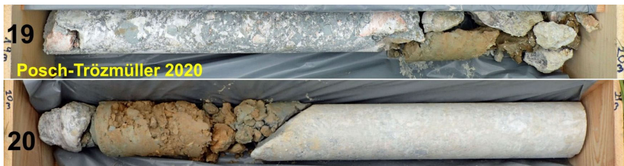
Abb. 1.9.: Beispiel eines verfüllten Hohlraums in einer Kernbohrung in Weissenbach in 19,7-20,5 m Tiefe (Posch-Trözmüller et al., 2021a).
