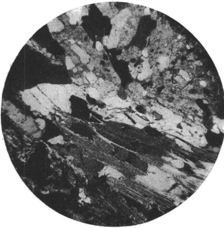
Fig. 433. Alkalifeldspatgneis von Oberharmersbach, Schwarzwald (Renchgneis). Samml. Grubenmann-Hezner. Polarisiertes Licht. Orthoklas, Plagioklas, Biotit. Granoblastisch-schieferiges Gefüge mit Anklang an Siebstruktur der Kontaktgesteine. Sedimentgneis.
