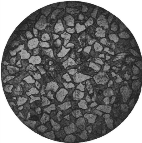
Fig. 367. Sandstein mit eckigen Quarzkörnern und kalkigem Bindemittel. Aus dem Weald am Stemmerberge bei Hannover.
