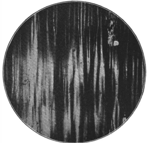
Fig. 163. Mikroklin. Schnitt senkrecht Fläche M und parallel der Vertikalachse (Fig. 157) im polarisierten Lichte.
