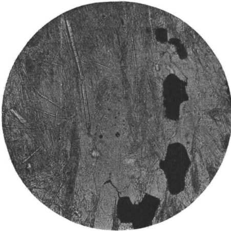
Fig. 428. Sedimentgneisquarzit v. Gellivaara (Schweden). Samml. Grubenmann-Hezner. Quarz, viel Sillimannit, Magnetit.
