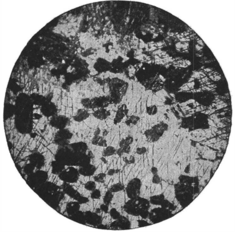
Fig. 241. Poikilitisches Gefüge. Hornblendeperidotit von Schriesheim (Odenwald).
