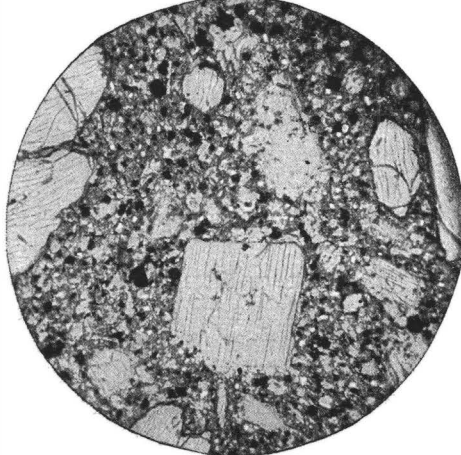
Fig. 304. Nephelinbasalt. Wohlbach bei Adorf (Sachsen). Mitten unten Augit; links und rechts oben Olivin; helle kleine Durchschnitte Nephelin; Erz dunkel.
