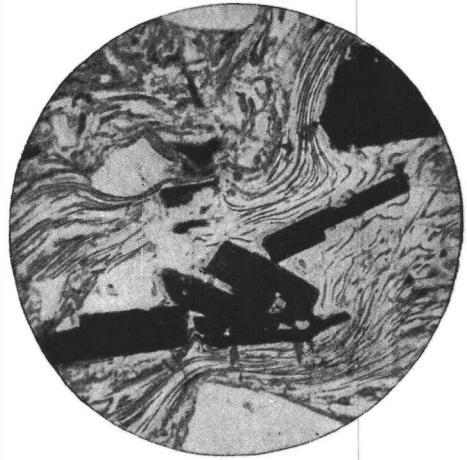
Fig. 285. Quarzvitrophyr. Auer an der Etsch. Unten Feldspat, Mitte links Quarz, Glimmer dunkel, fluidale Grundmasse.
