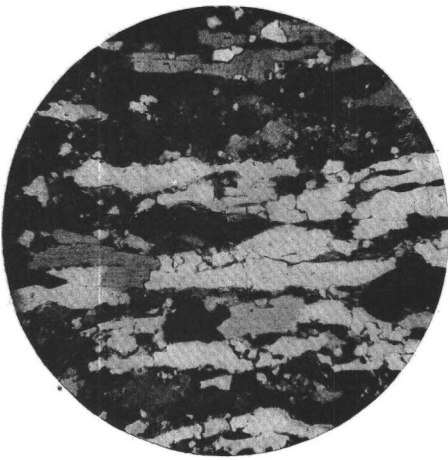
Fig. 437. Alkalifeldspatgneis (Granulit) v. Chemnitz (Sachsen). Samml. Grubenmann-Hezner. Orthoklas und Quarz, letzterer langgestreckt. Grano-nematoblastisch-schieferiges Gefüge.
