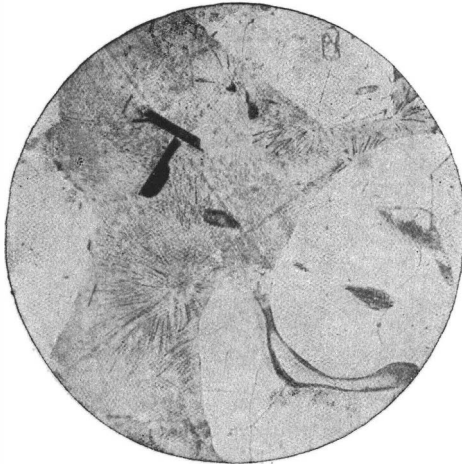
Fig. 284. Liparit. Apati (Ungarn). Rechts unten und links verrundeter Quarz, rechts oben Feldspat, Glimmer dunkel, sphärolithische Grundmasse.
