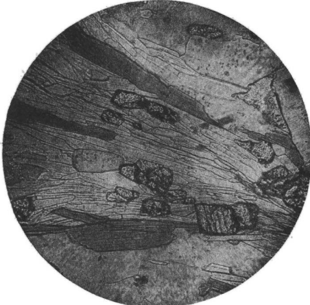
Fig. 435. Muscovit-Biotitgneis v. Simplon. Samml. Grubenmann-Hezner. Mit Epidot (Relief). Granoblastisch bis lepidoblastisch-schieferiges Gefüge.
