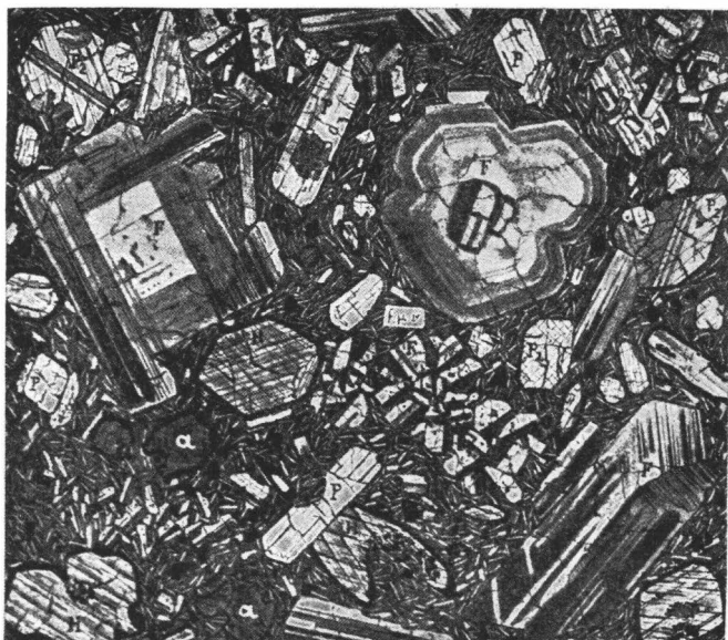
Fig. 177. Hornblendeandesit von Chabet Fleah (Oran). Nach Gentil. L Labrador mit Zonenstruktur; P Orthaugit; P 2 Klinaugit; H Hornblende. In der Grundmasse f Plagioklas; μ Magnetit; γ Glas.
