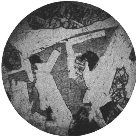
Fig. 298. Olivindiabas von Asby (Schweden). Sperrige Leisten von Plagioklas mit Augitfülle; zerklüftete Körner von Olivin; Erz.
