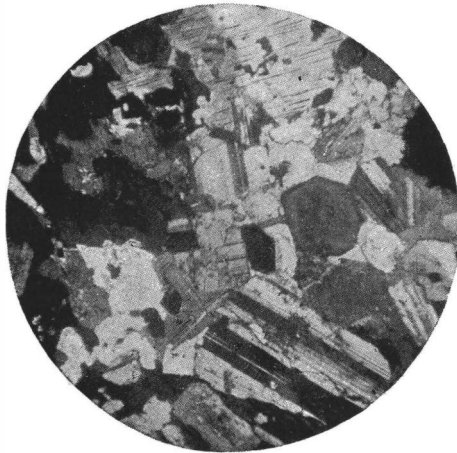
Fig. 266. Diorit. Neuntenstein bei Hohwald (Vogesen). Gestreifte Durchschnitte Plagioklas, oben Hornblende, links (hell) Quarz, Erz und Biotit dunkel.
