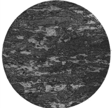
Fig. 436. Hornblendeschiefer von Miltitz b. Meißen (Sachsen). Samml. Grubenmann-Hezner. Hornblende und Albit. Nematoblastisch-schieferiges Gefüge.
