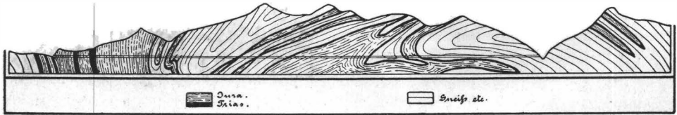
Fig. 443. Geologisches Profil längs der Achse des Simplontunnels. Nach C. Schmitt und H. Preiswerk.
