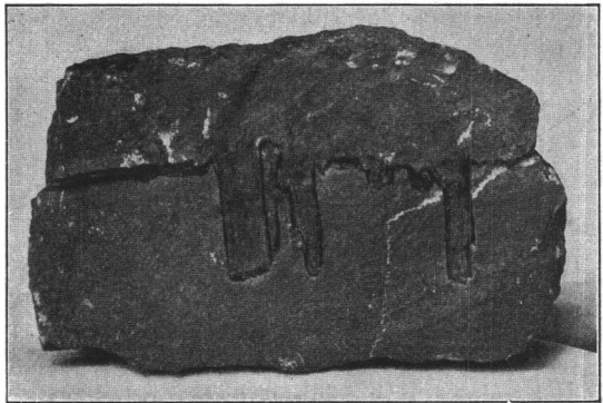
Fig. 398. Sutura und Stylolithen in Kalkstein.
