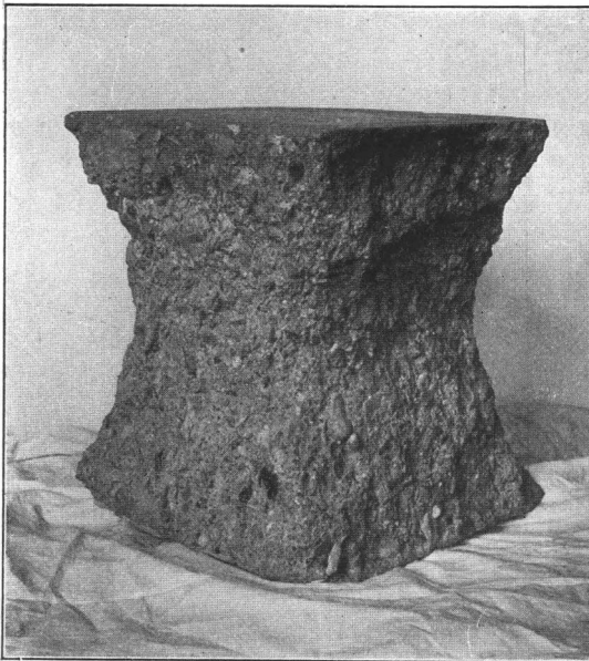
Fig. 200. Betonwürfel nach dem Druckversuch.
