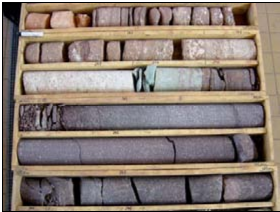
Abb. 30: Bohrung Oelsnitz 1A/2003 Grenze der Oberen Planitz-Formation mit Rochlitz-Ignimbrit, Bleichungen im Top und Basiskonglomerat der Leukersdorf-Formation ab 385,5 m
