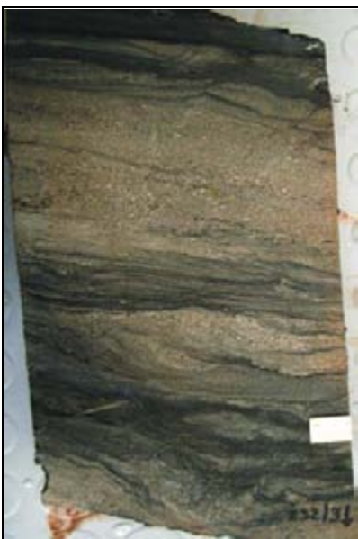
Abb. 23: Bohrung Oelsnitz 1A/2003 Sedimentstrukturen des Oberkarbons; hal- bierter Bohrkern von 545,0-545,8 m (Foto JASCHKE 2005)
