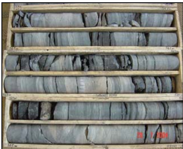
Abb. 17: Bohrung Oelsnitz 1A/2003 Teufenbereich 560,0 - 566,0 m, Neufözkomplex 4: 561,48-561,64 m, 561,8-561,85 m, 562,08-562,25 m, 562,44-562,73 m, 563,73-564,27 m
