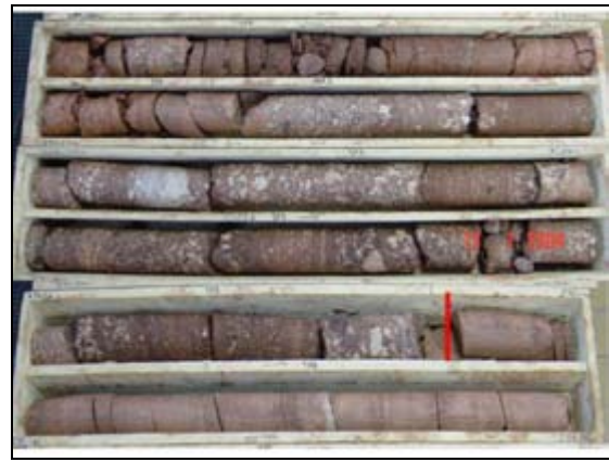
Abb. 31: Bohrung Oelsnitz 1A/2003 Basiskonglomerat des Großzyklus 2 der Unteren Leukersdorf-Formation bei 274,8 m
