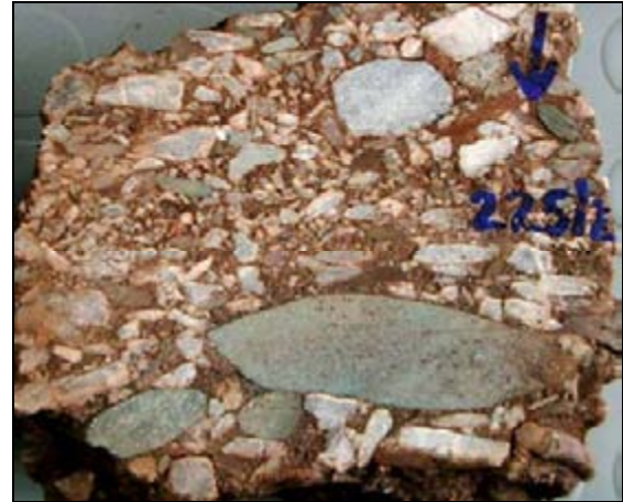
Abb. 26: Bohrung Oelsnitz 1A/2003 Grobklastika der Härtensdorf-Formation, Probe 225/2, Teufe 428,9-429,0 m (Foto JASCHKE 2005)
