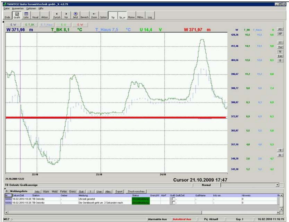
Abb. 11: Kontrollmonitoransicht in der BfUL Chemnitz (grün - Außentemperatur im Messstellenhaus, rot – Grubenwasserstand)
